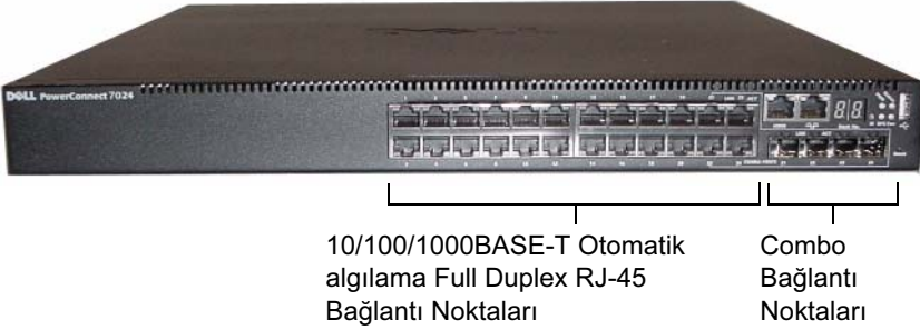
Şekil 1-1. 24 10/100/1000BASE-T Bağlantı Noktalı PowerConnect 7024
